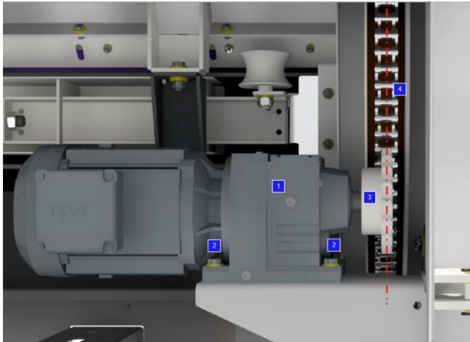
(Abb. Mittige Ausrichtung des Kettenrades auf die Trommelkette.)
