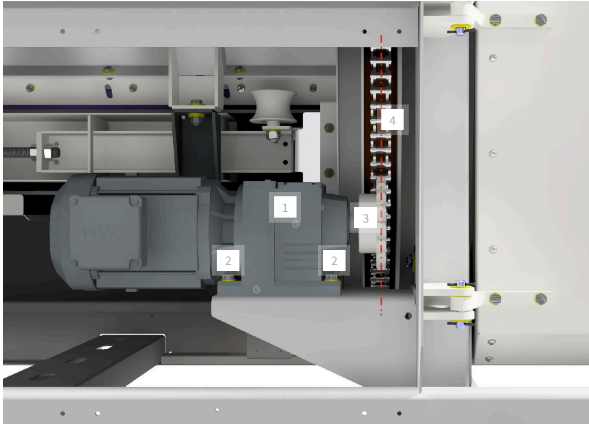
(Abb. Mittige Ausrichtung des Kettenrades auf die Trommelkette)
